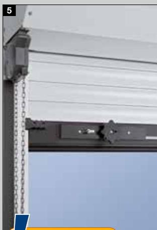
En commande manuelle, la porte de garage enroulable est verrouillée mécaniquement par les poignées intérieure et extérieure ainsi que par une serrure. Ce faisant, de solides pènes métalliques s'engagent dans les rails de guidage de chaque côté de la porte.
