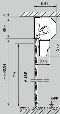
Domaine dimensionnel des portes de garage à enroulement intérieur et extérieur
